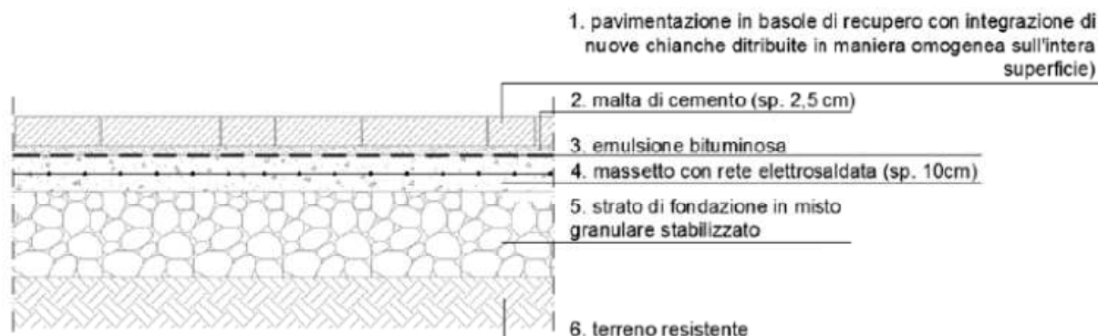
Figura 3 – Caratteristiche della modalità di posa delle basole.
